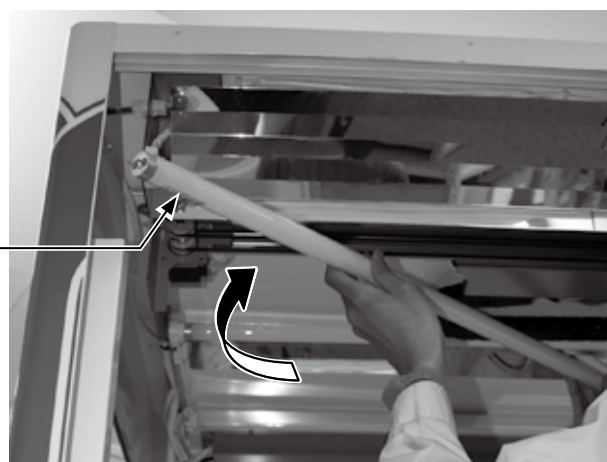
高周波点灯専用直管形蛍光灯 FHF32W 390-6921-32-01 (Hf 専用)
