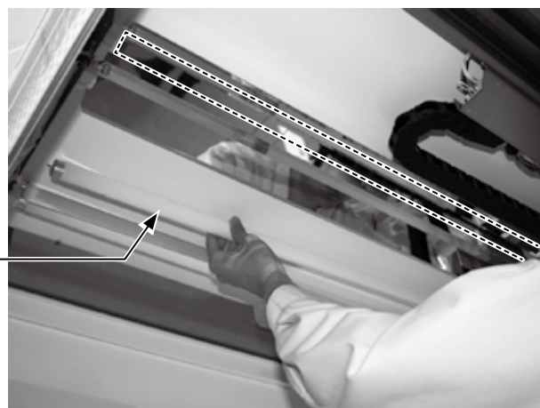
高周波点灯専用直管形蛍光灯 FHF32W 390-6921-32-01 (Hf 専用)
